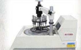
自動岩石薄片拋光機 Automatic rock thin slice polisher
